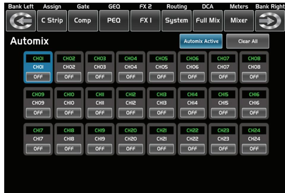
随机选定两到三个输入信道打开Automix功能，将被选信道都分配给一个输出通道如Main，使用固定频点信号提供给所选输入，Main通道Gain值将稳定不变。
