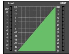
此区域的网格线实时显示压缩器触发电平-threshold。左边的电平表显示输入信号电平的活动，右边的电平表指示压缩程度。
