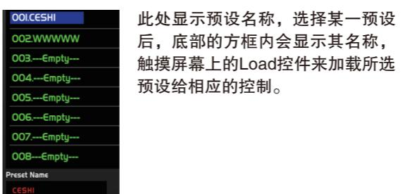
此处显示预设名称，选择某一预设后，底部的方框内会显示其名称，触摸屏幕上的Load控件来加载所选预设给相应的控制。
