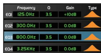
触摸EQ1设定其频率、Q值及增益参数，触摸Type改变滤波器类型，可选为高通、低通和带通，EQ2、EQ3和EQ4与其相同，在屏幕上可看到波形图的变化。
