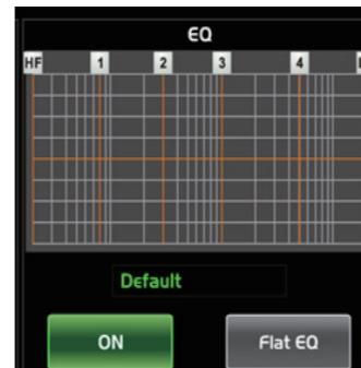
触摸ON/OFF开关使能EQ功能, 此开关会和EQ页面的相应开关同步作用。此页面EQ值不可调, 只能显示已在EQ页面调节好的相应曲线。中间的小方框显示的是在EQ页面载入的预设名。
