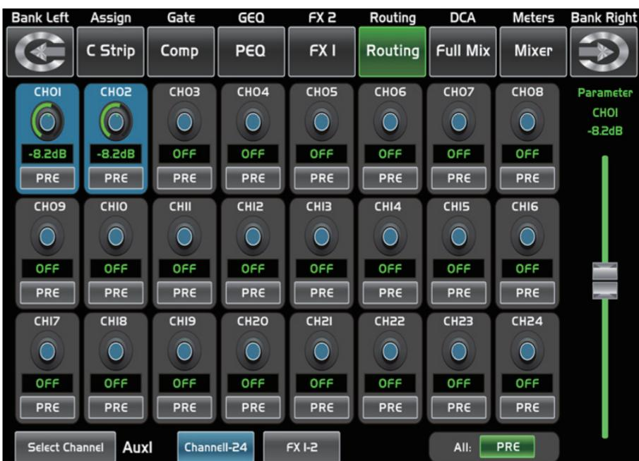
此页面中，以此控件为例，触摸它可将CH01路由到AUX1通道，调节Adjust Parameter旋钮或滑动屏幕右边的长推杆可以更改所选的通道音频电平。触摸此屏幕上的PRE标志，切换到POST，其背景亮。来自于所有其它通道的，并传送到此信道的信号将置于推杆后。若此控件未被选中，则按默认设置，这些信号将会置于推杆前，从而不受推杆位置变化的影响。此页面中link可作用于所有通道。
