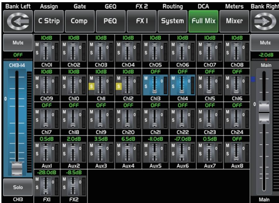
触摸某通道，其背景和相应的Select按键会同时点亮，可以通过调节Adjust Parameter旋钮来控制其输出信号电平。左边的电平表指示输入信号电平的变化，右边的电平表指示主通道电平的变化。
