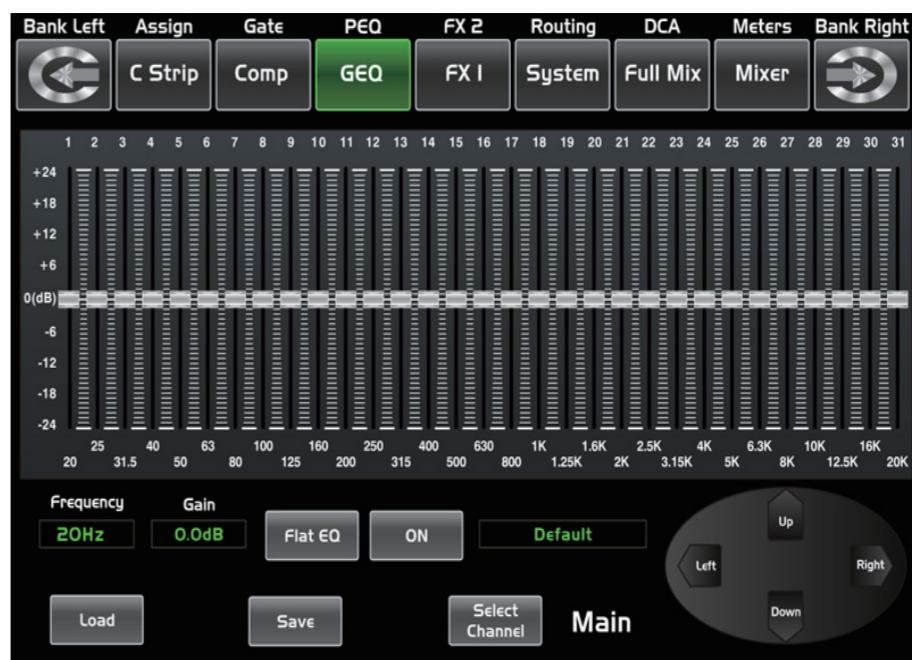
本产品有主输出立体 (MAIN Stereo) 和辅助单音 (AUX Mono)，31段EQ，1/3八音图示EQ。31段EQ范围为20Hz至20KHz。采样率为24-bit/48kHz，此时有1个主输出立体GEQ，8个辅助单音GEQ。
