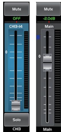
在屏幕上滑动此推杆，可以增加或减少相应通道电平。旁边的电平表指示输入信号电平的变化。
