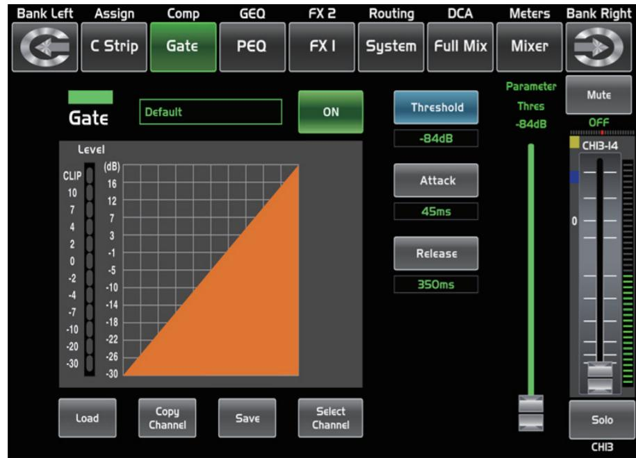
**ON** 触摸此开关控件来控制所选信道是否具有噪音门限功能，此控件会和面板上的Gate按键同时亮或灭，LCD上实时显示门限设置，通过调整LCD上的触发电平-Threshold、噪声门启动-Attack和噪声门释放-Release来调整参数，或者可转动Adjust旋钮来设定。
